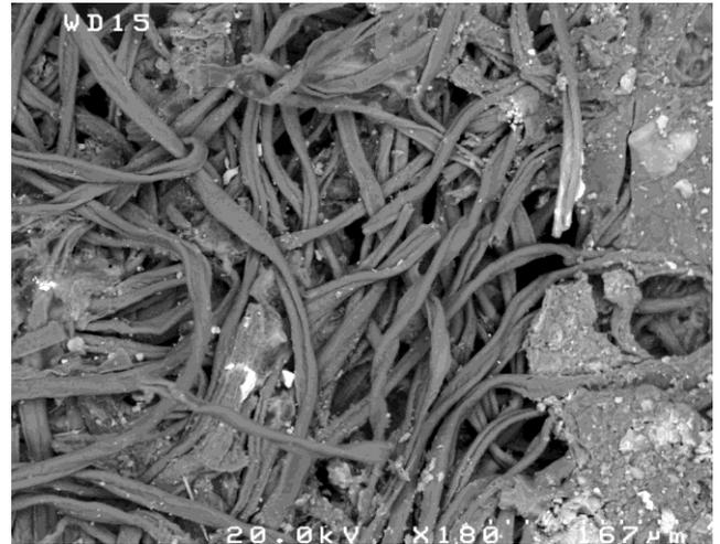
Figure 7 : Vue de détail (MEB, ERD, x180) des fibres constitutives du papier support de la mosaïque de plume.
