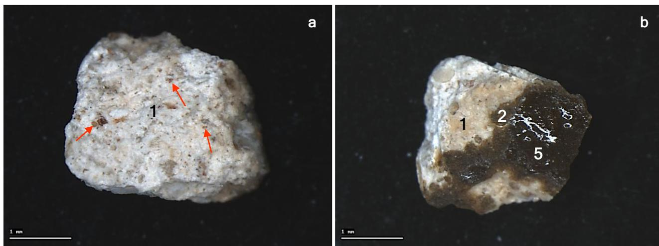
Figure 10 : Vues d'ensemble (stéréomicroscope, x10, **a**- face interne, **b**- face externe) du prélèvement P3.
